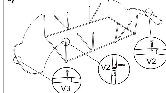
2) Préparer le montant de porte : assembler les deux tubes (n°9 et 10) à l'aide d'une vis et d'un écrou.
