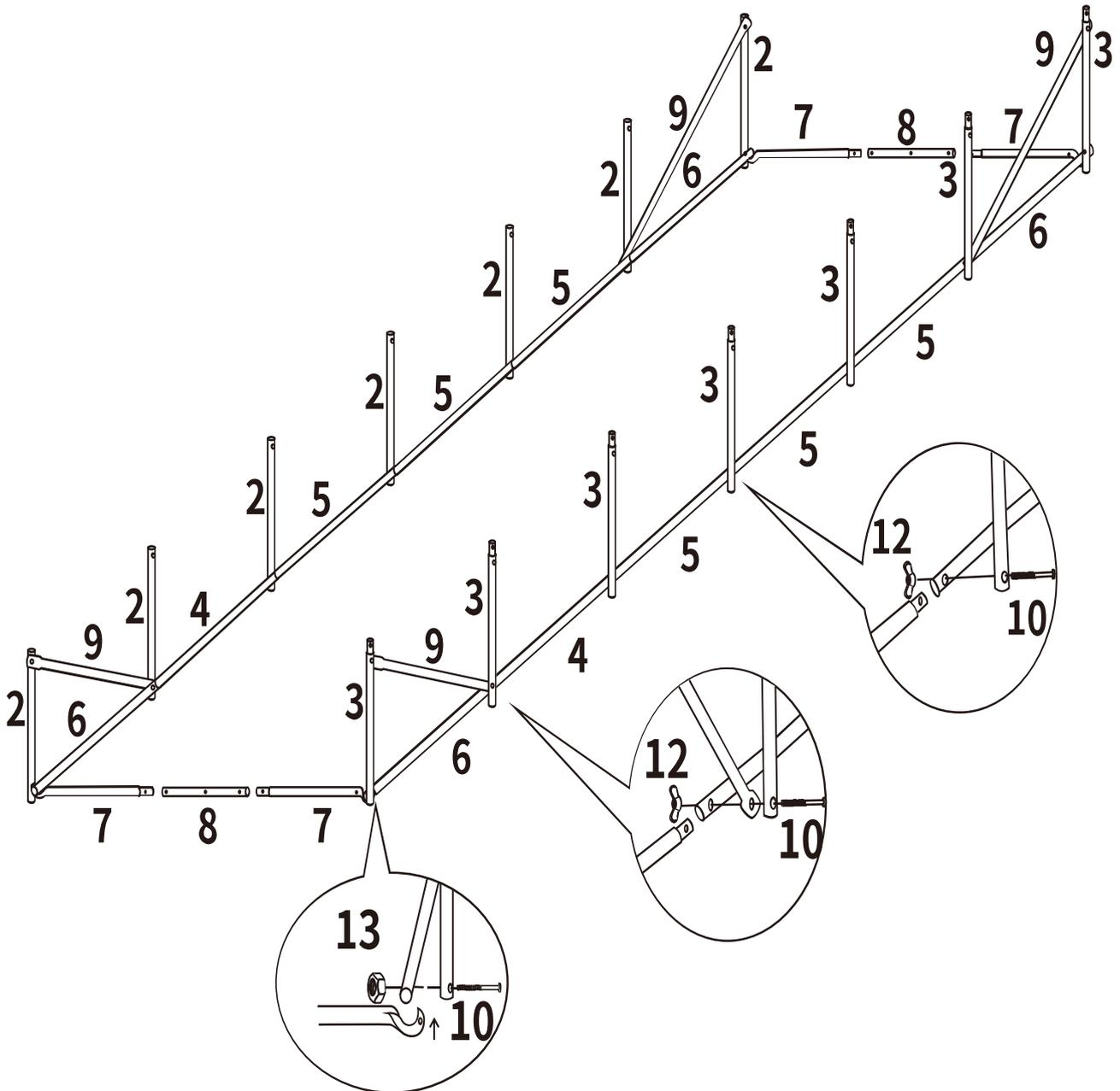
Monter la base de la structure de la serre en suivant le plan ci-dessus. Les barres de contreventement N°9 sont prises entre les montants et les longerons, ceci à chacune de leur deux extrémités (Etape 1 & Etape 2).
