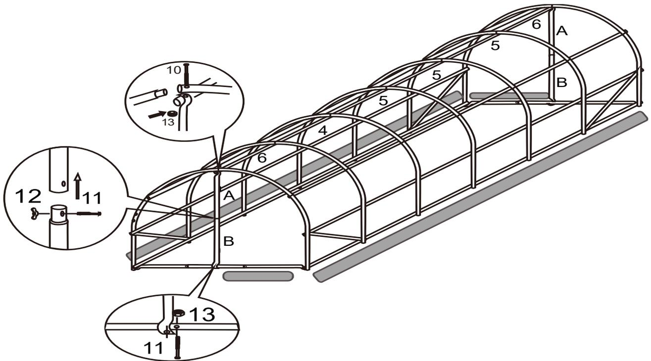
Une fois cet assemblage terminé, et pour un maximum de stabilité, nous vous recommandons de creuser des tranchées d'environ 20 cm de largeur et 30 cm de profondeur à l'aide d'une bêche/pelle sur tout le pourtour de la serre (sauf portes) comme illustré avec les bandes grisées sur le schéma ci-dessus, pour y enterrer par la suite les surplus périphériques de bâche.
