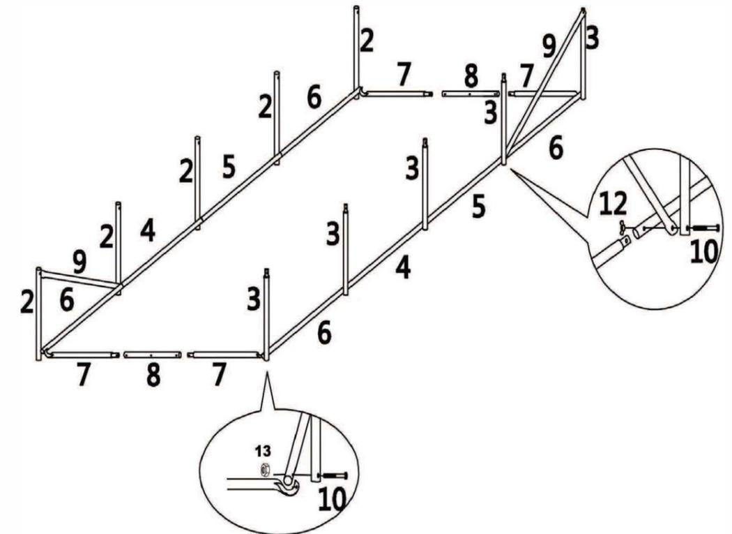
Monter la base de la structure de la serre en suivant le plan ci-dessus.
