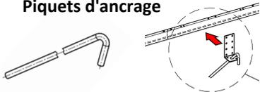
Une variante de fixation au sol par piquet d'ancrage est **possible seulement si le terrain où sera montée la serre est assez dense (pas de sol meuble). Auquel cas utiliser uniquement les piquets d'ancrage fournis.**
