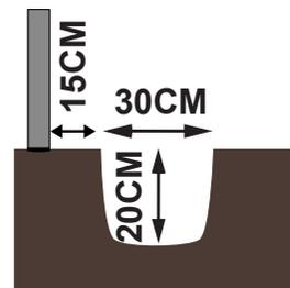
Avec une bêche/pelle, creuser une tranchée d'environ 25-30CM de large et 20CM de profondeur sur le pourtour de l'armature, sauf au niveau de la porte.
